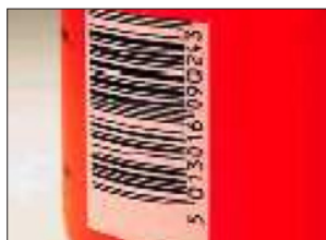
Marge trop courte
